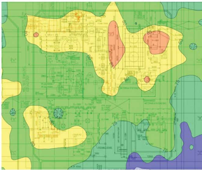
รูปที่ 47 แผนผังแสดงเส้นระดับเสียง (Noise Contour Map)บริเวณ UT โครงการโรงงานผลิต Polyethylene Terephthalate (PET) บริษัท ไทยเพ็ท เรซิน จำกัด
